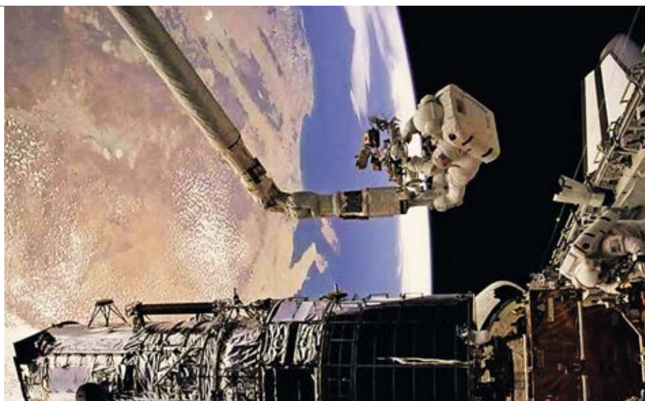
Une sortie extravéhiculaire de deux astronautes (Story Musgrave au bout du bras robotique, et Jeff Hoffman dans la soute de la navette), pour des travaux de réparation du télescope Hubble lors de la mission STS-61
